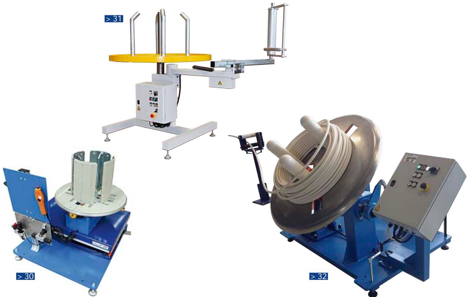
Zum Abrollen von Draht-, Rohr- und Profilmaterial mit Durchmesser bis 16 mm. Unser Sortiment umfasst gebremste sowie angetriebene Geräte mit Tragkräften von 10 – 6000 kg. Je nach Prozessbedarf stehen wiederum alle unsere entsprechenden Abtastsysteme zur Verfügung.
