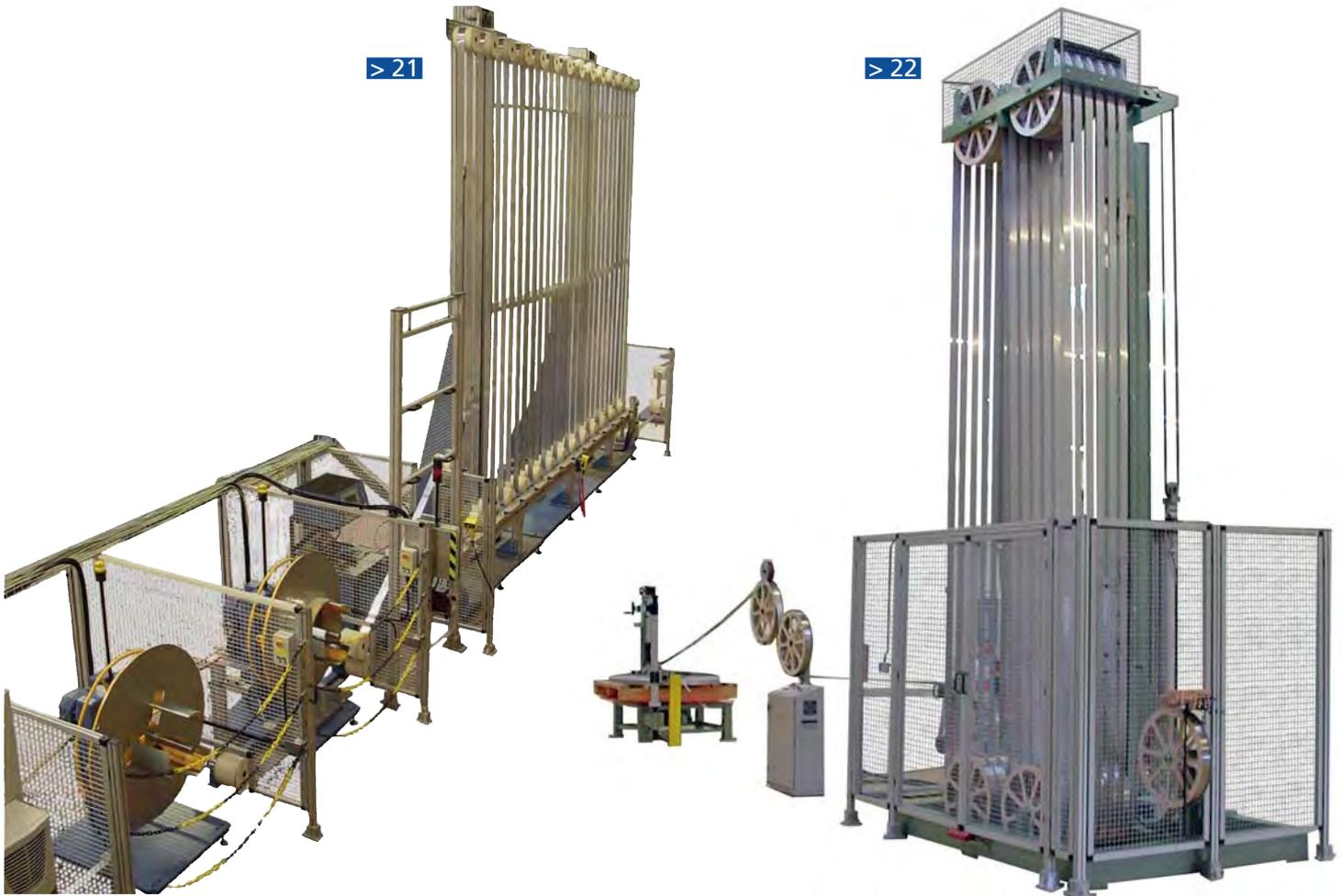
Die hohen Produktivitätsansprüche in der Verbundrohr-Produktion erfordern Bandzuführanlagen mit Bandspeichersystem.
