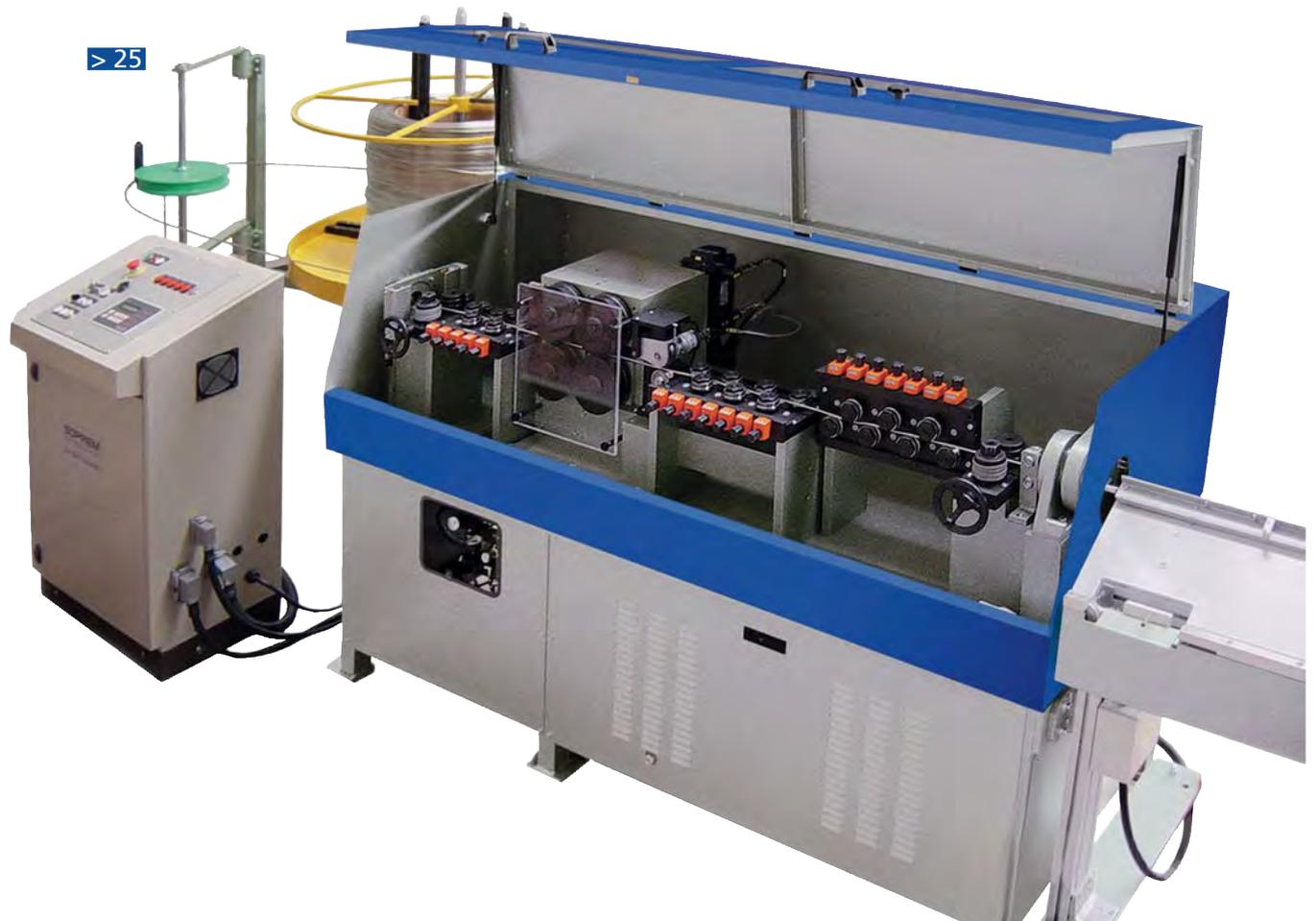
Moderne Fertigungsbetriebe automatisieren die Drahtzuführung mit Abrollhaspel, Richt-Vorschubsystem und Längsteilvorrichtung.
