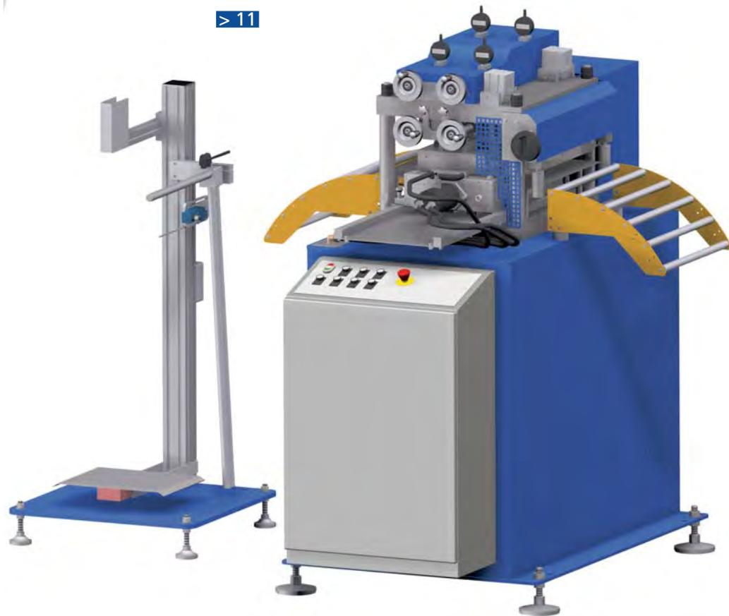
In der Stanztechnik wird vor der Presse immer öfter eine motorisierte Band-Richtmaschine eingesetzt. Das Richten schont das Werkzeug und schafft ein formgenaueres Teil. Da das Band über die Schlaufe zugfrei in den Walzenvorschub gegeben wird, können höhere Kadenzen gefahren werden.
